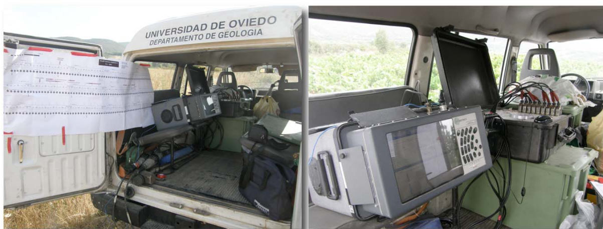
Figura 5.- Vista general del centro de control instalado en un todoterreno. En la imagen de la derecha se puede ver en un primer plano el sismógrafo Geometrix StratavisorNX y en un segundo plano el Rollalong.
