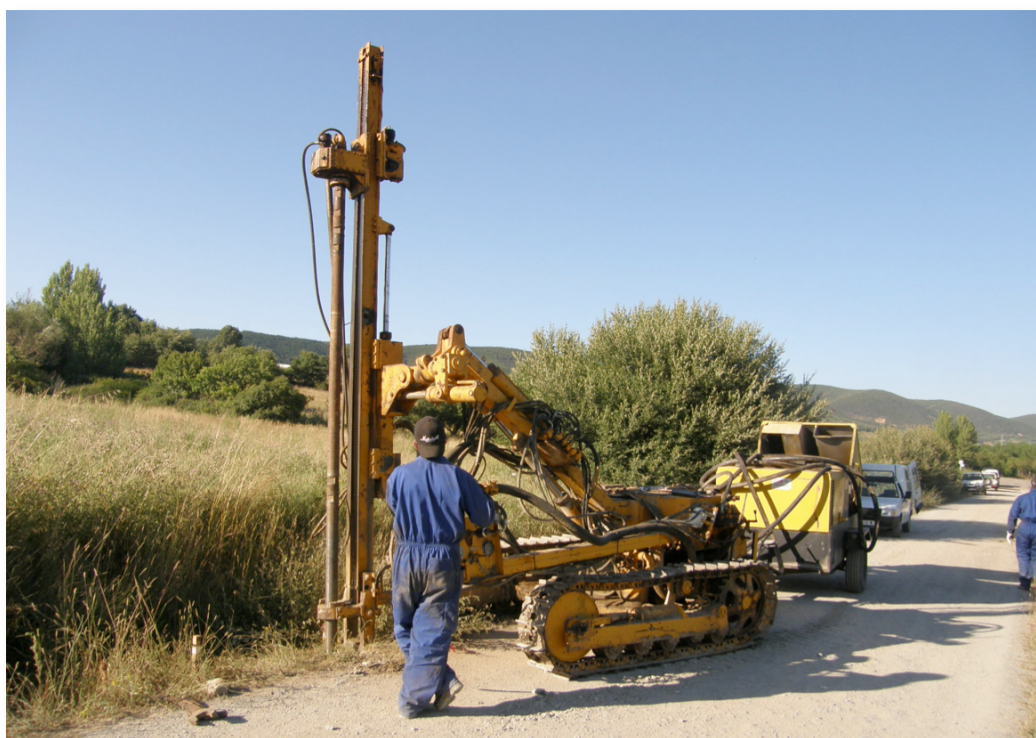
Figura 4.- Máquina perforadora con la que se hicieron la mayor parte de los pozos para la colocación del explosivo en todos los trabajos sísmicos..
