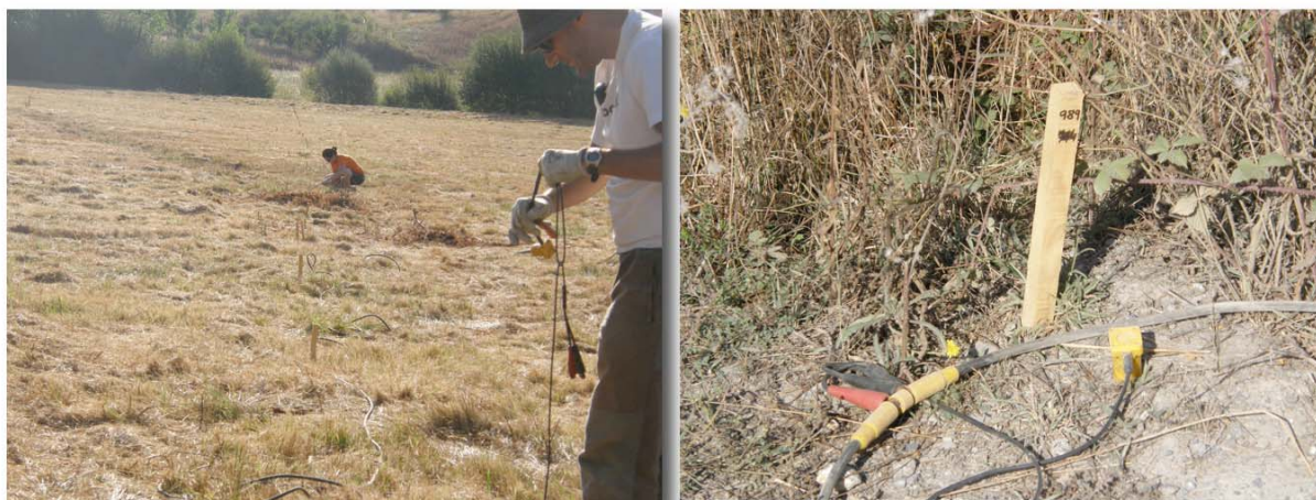
Figura 6.- Detalles del despliegue del dispositivo. A la izquierda se puede ver la línea marcada con estacas y los trabajos de implantación de los geófonos; a la derecha, vista ampliada de un geófono clavado en el suelo.
