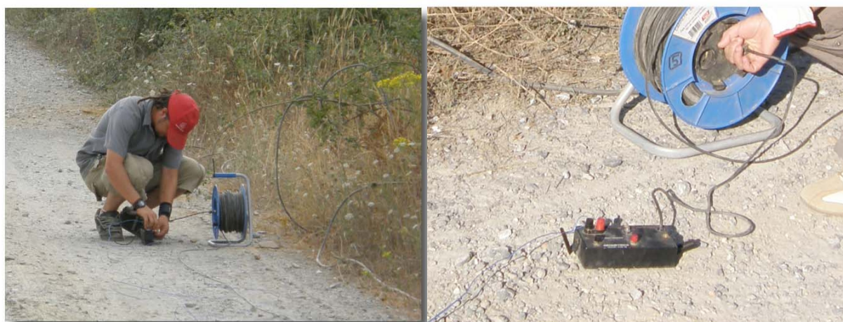
Figura 9.- Explosor Geometrics HVB-1 utilizado para detonar los tiros. A la izquierda, los cables del detonador se conectan a los bornes del explosor; a la derecha, la salida de "trigger" del explosor se conecta a la bobina de cable coaxial para llevar la señal hasta el sísmógrafo.
